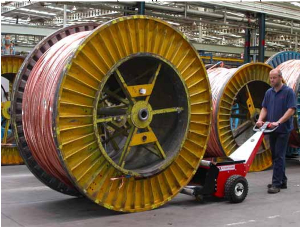
Stuart Chetwyne (Pirelli Cables, Wrexham) spinge una bobina di cavi del peso di 9 tonnellate utilizzando un'unità Nu-Star Power Pusher
