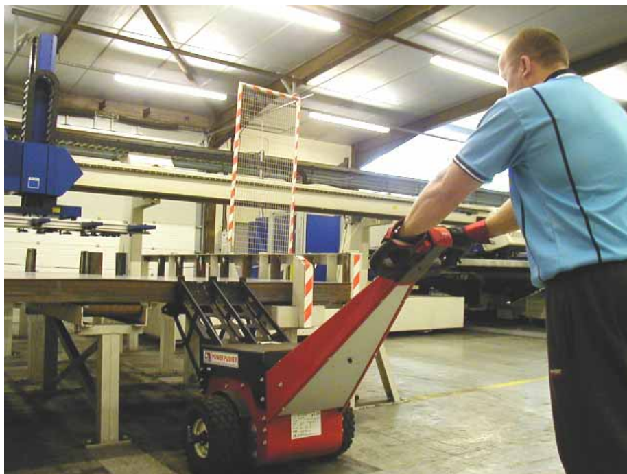
Kevin Woods di Permastore mentre inserisce una lamiera di acciaio nella pressa Trumpf con un'unità Power Pusher
