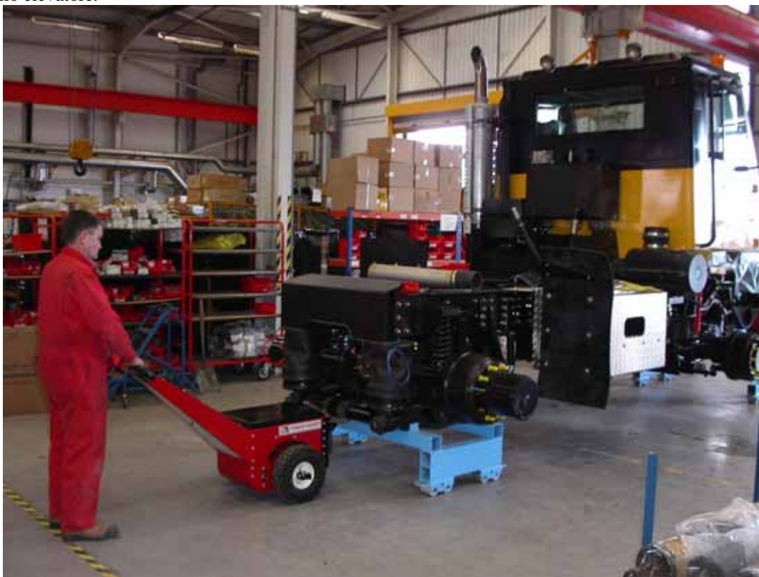
Alan Pearson, istruttore per l'uso delle apparecchiature di Multidrive, utilizza l'unità Power Pusher per spingere e tirare il nuovo rimorchio M8-40.
