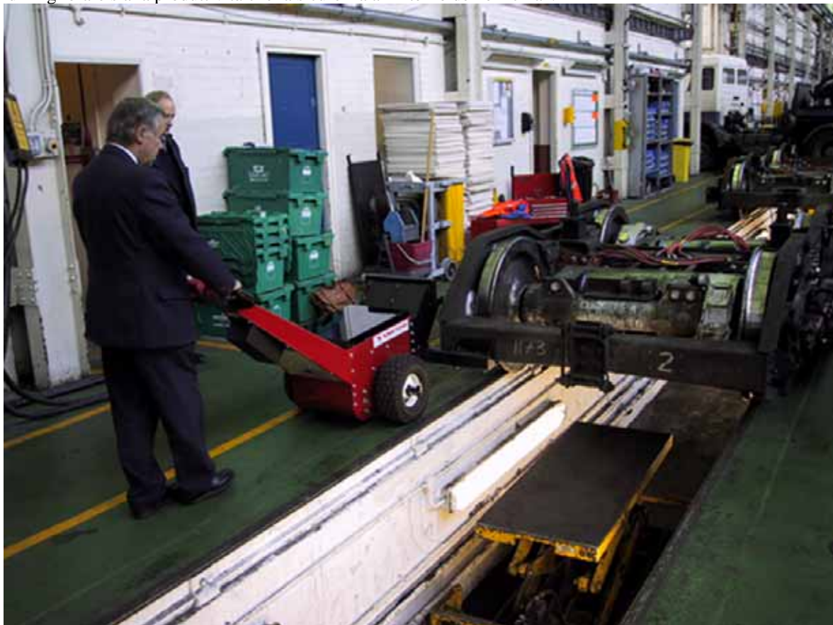
Mike Ruffell, responsabile tecnico, prova la nuova unità Power Pusher presso il deposito di Cockfosters
