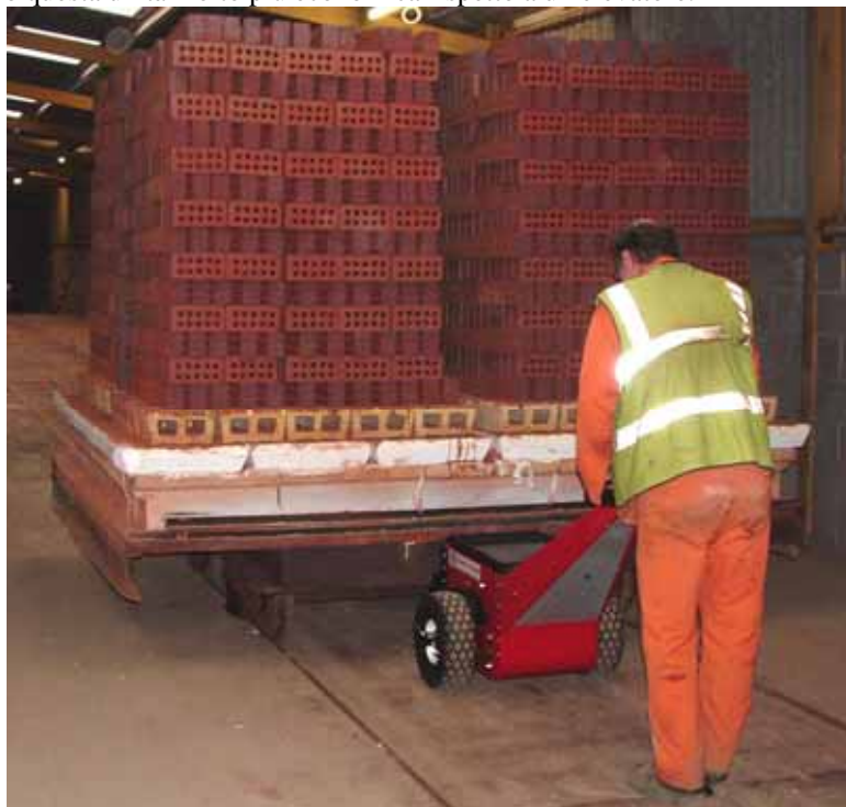
Neville Smith mentre usa l'unità Power Pusher per manovrare uno dei carri delle fornaci per laterizi da 12 tonnellate presso la sede di Hanson (Halifax)
