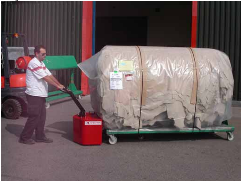
Kevin Hatton (addetto alle spedizioni di Eagle Ottawa, Warrington) utilizza l'unità Nu-Star PowerTug per la movimentazione di carrelli per il trasporto delle pelli
