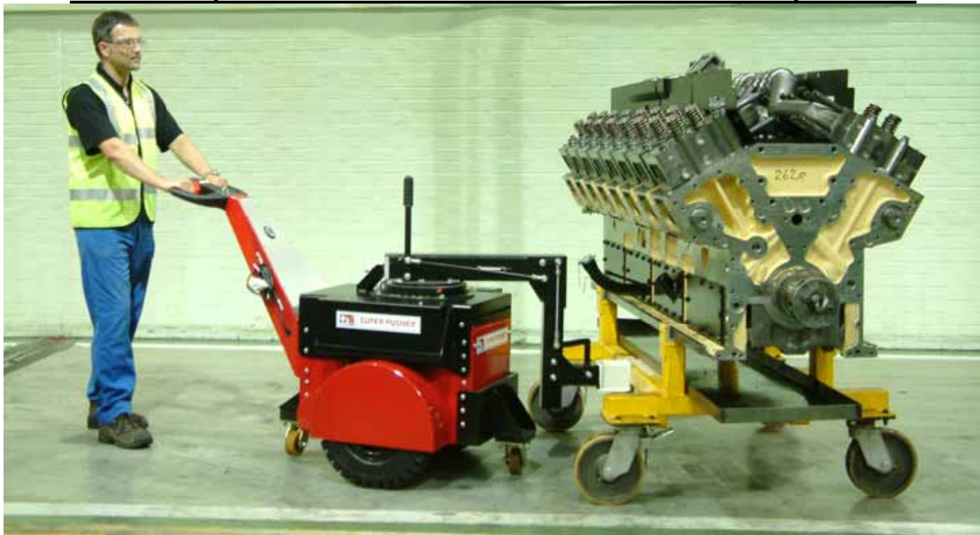
Eddie East mentre usa l'unità Nu-Star Super Pusher per manovrare uno dei motori diesel da 7000 kg e 16 KV
