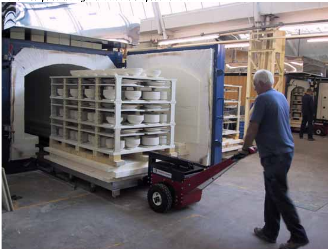
Harry Hunt, del personale di Churchill China plc, Stoke-on-Trent, spinge un carro da forno di 2 tonnellate utilizzando una delle unità Nu-Star Power Pusher
