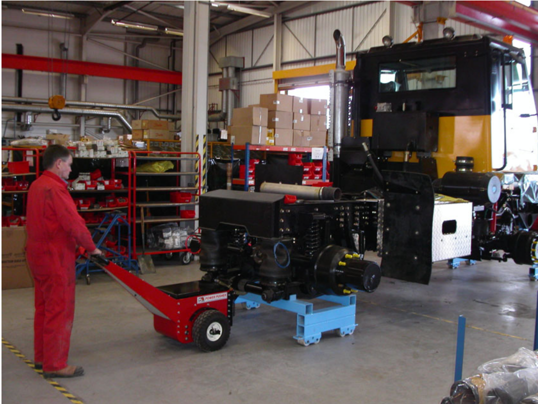
Alan Pearson (Formateur de Multidrive) utilisant le Power Pusher pour pousser et tracter le nouveau tracteur M8-40.
