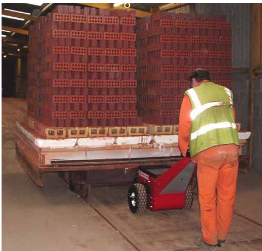
Neville Smith manœuvrant le Power Pusher pour déplacer un wagonnet de briques de 12 tonnes à Hanson, Halifax
