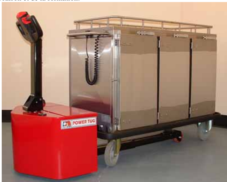
PowerTug de Nu-Star servant à déplacer les chariots chauffants Corsair à la maison d'arrêt de Winchester
