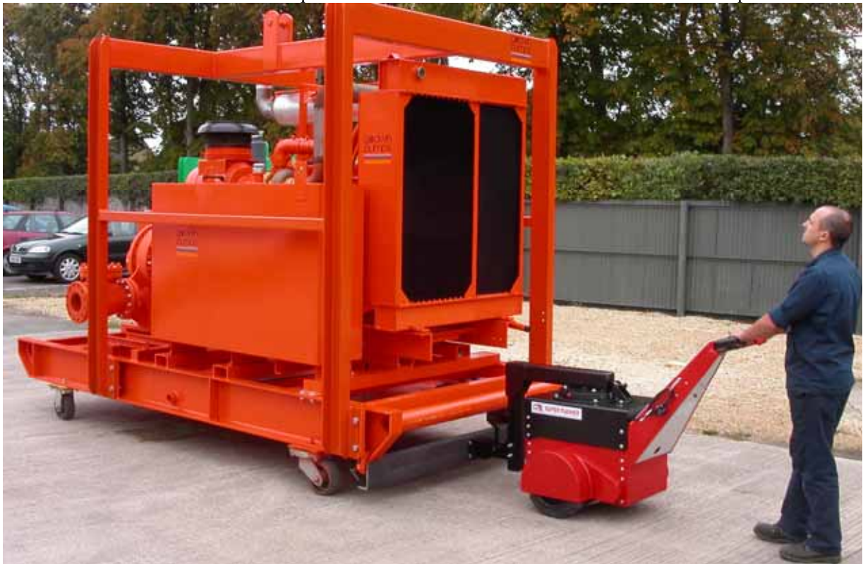
Richard Godwin manœuvrant le Super Pusher de Nu-Star pour déplacer une pompe Godwin de 4 800 kg
