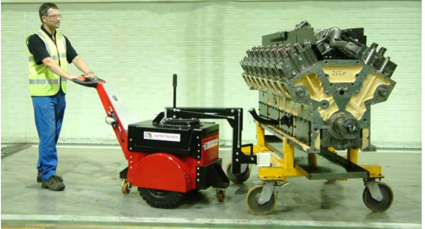
Eddie East manœuvrant le Super Pusher de Nu-Star pour déplacer l'un des moteurs diesel KV16 de 7000 kg
