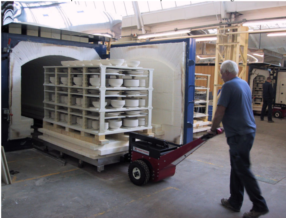
Harry Hunt (Churchill China plc) introduisant un wagonnet de 2 tonnes dans le four à l'aide d'un Power Pusher de Nu-Star
