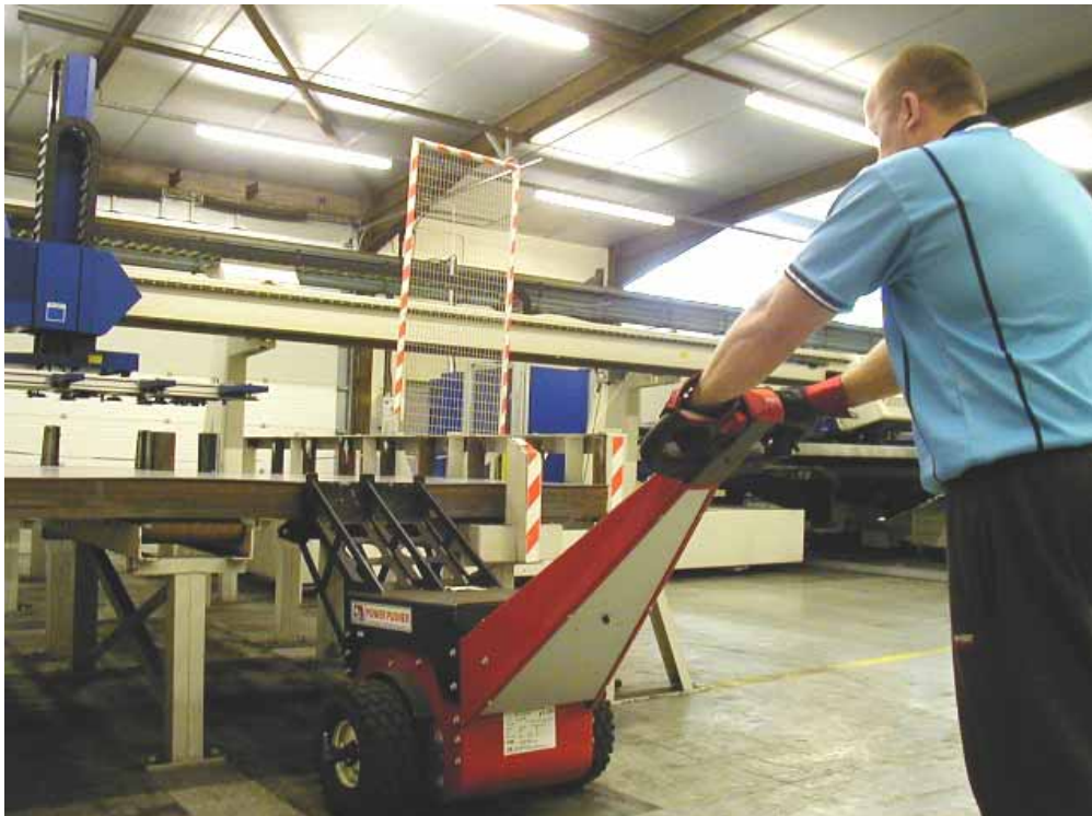
Kevin Woods, de Permastore, introduce las chapas de acero en la prensa Trumpf con la Power Pusher
