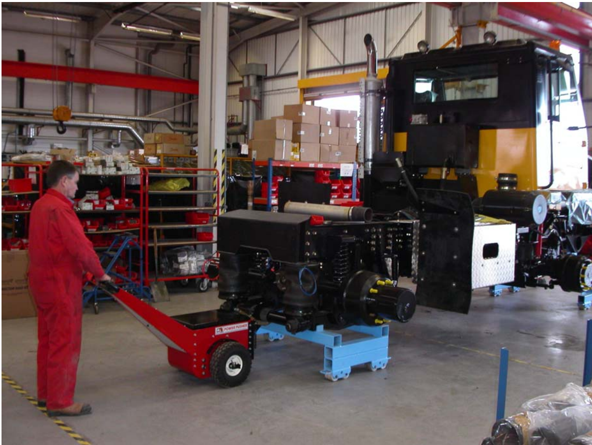
Alan Pearson, instructor de equipos de Multidrive, utilizando la Power Pusher para empujar y arrastrar el nuevo camión tractor del M8-40
