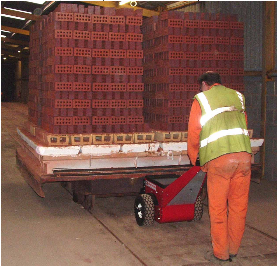
Neville Smith empuja un carro de horno de ladrillos de 12 toneladas con la Power Pusher en la planta de Hanson de Halifax
