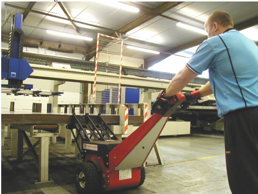
Kevin Woods von Permastore mit dem Power Pusher zur Versorgung der Trumpf-Presse mit Stahlblech
