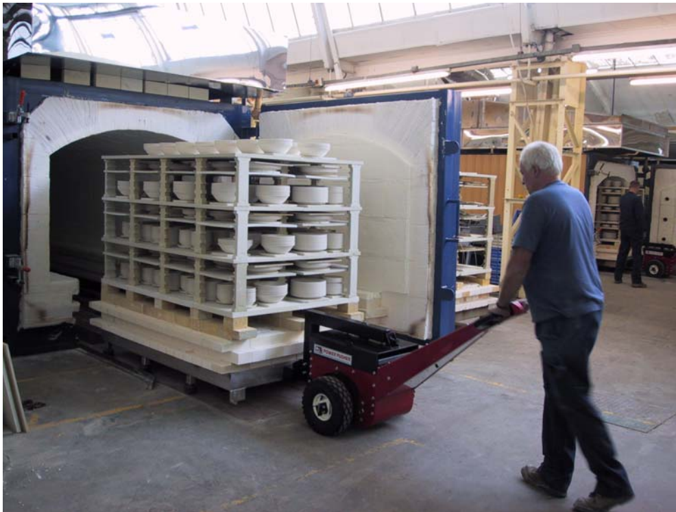
Harry Hunt (Churchill China plc, Stoke-on-Trent) schiebt einen 2 Tonnen schweren Brennofenwagen mit einem Power Pusher von Nu-Star in den Ofen.
